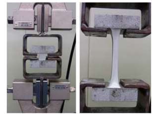
H型試験体による引張接着性試験 (左：初期状態 / 右：最大荷重時)
