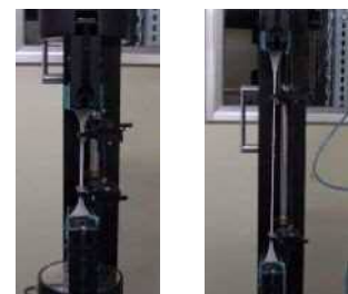
ダンベル状試験体(伸び800%以上)
