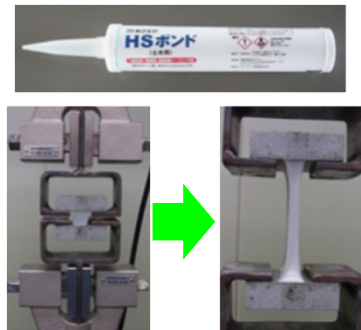
コンクリート接合部の耐震止水工法 HSB工法 (NETIS : TH-17005-VR)
